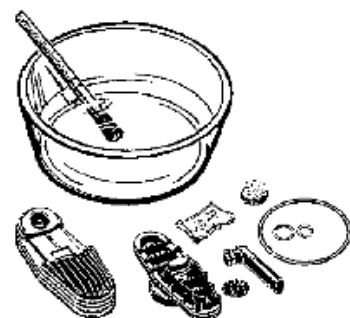
Ruční čištění rozložené chladicí jednotky
